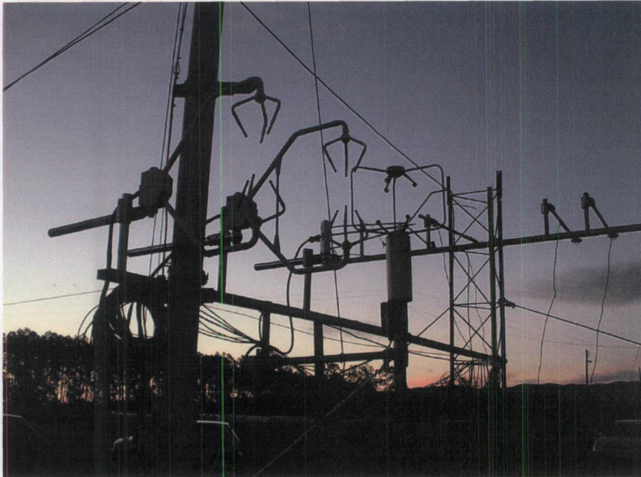
Figura 7: Calibração dos anemômetros sônicos , realizada no laboratório da UFSM, antes do início da campanha intensiva.
