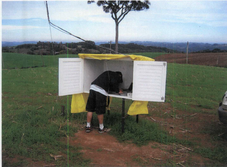
Figura 14: Abrigo construído para o sistema de aquisição de dados;
