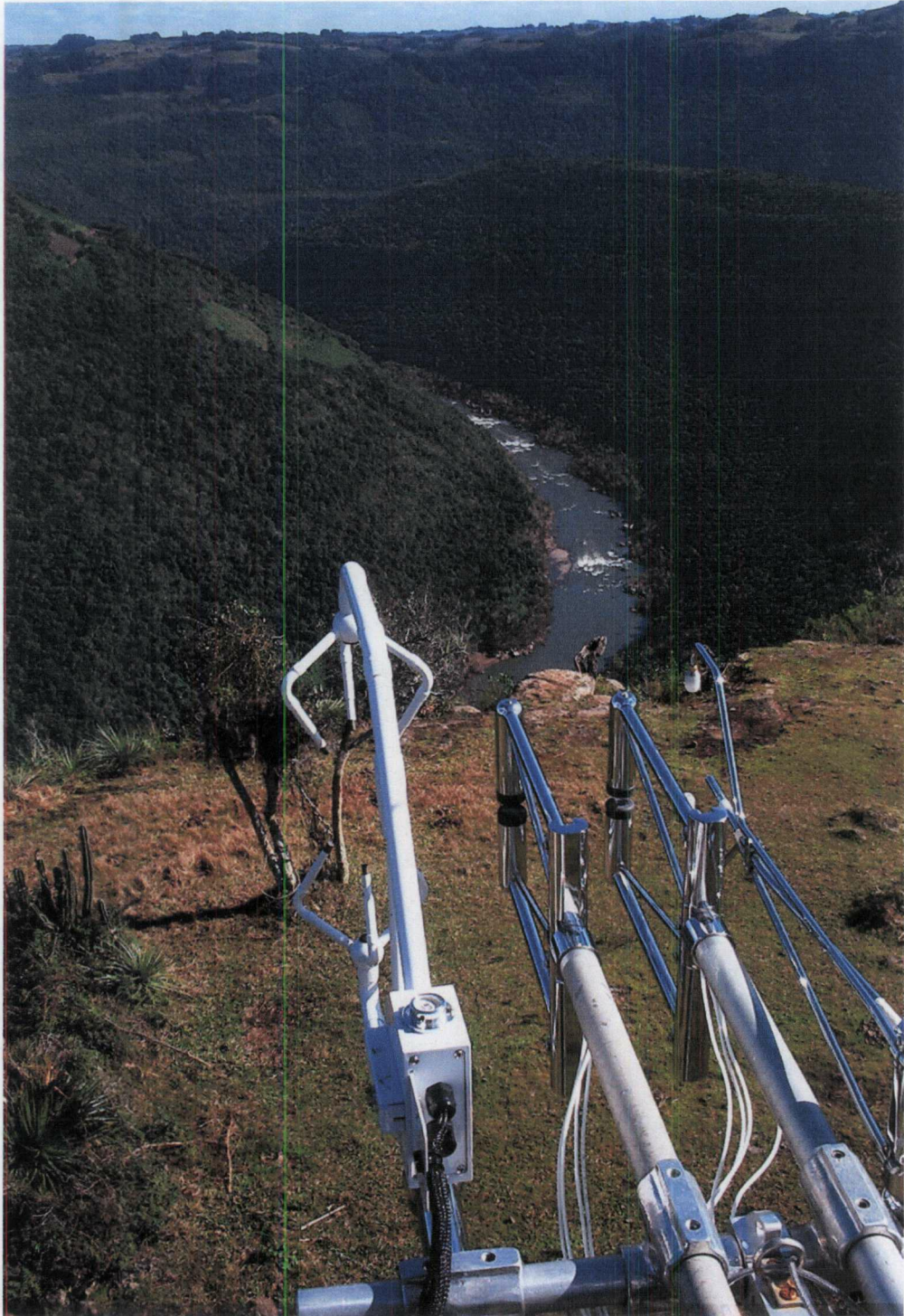
Figura 12: Sensores de fluxo na torre de São Roque.
